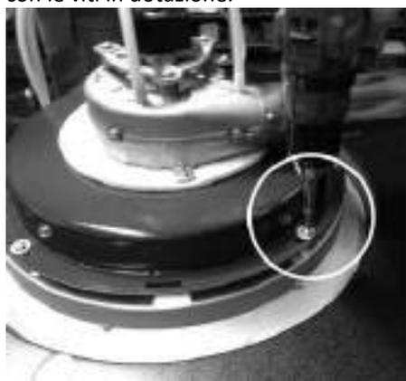
Fissare la staffa porta cavi in posizione verticale (utilizzare esclusivamente le viti in dotazione )
