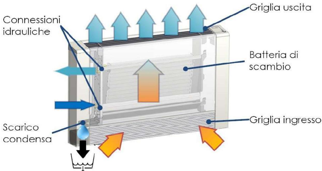
In estate l'unità aspira dalla griglia frontale l'aria calda e umida e la convoglia in maniera silenziosa mediante il ventilatore DC Inverter attraverso la batteria di scambio termico. La batteria preleva calore dall'aria, raffreddandola e deumidificandola, e lo trasferisce al circuito idraulico alimentato con acqua fredda. Attraverso la griglia superiore l'aria, raffreddata e deumidificata, ritorna in ambiente.
