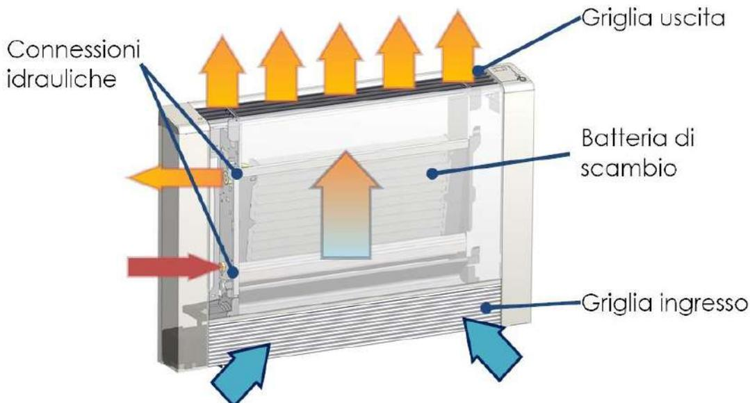
In inverno l'apparecchio aspira dalla griglia frontale l'aria fredda e la convoglia in maniera silenziosa, mediante un ventilatore tangenziale asimmetrico accoppiato a un motore DC Inverter, attraverso una batteria di scambio termico. Compito della batteria è di trasferire il calore proveniente dal circuito idraulico all'aria, riscaldandola. L'aria riscaldata viene immessa nell'ambiente attraverso la griglia superiore.
