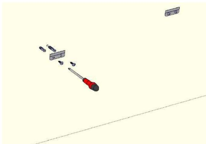
Con una livella verificare l'allineamento orizzontale delle due mensole. Se necessario sfruttare le asole, ricavate all'interno delle mensole, per regolarne la posizione.
