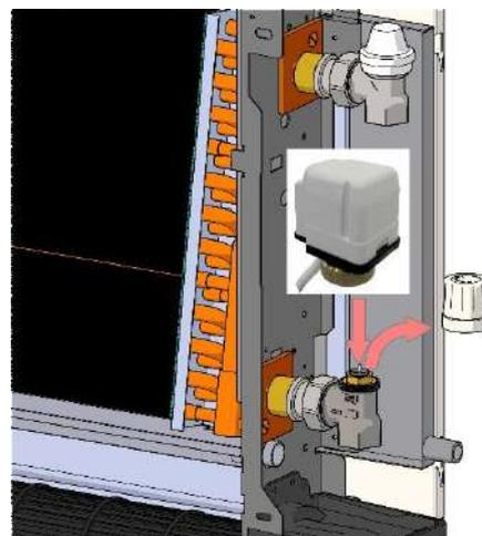
Per agevolare il passaggio dei tubi è possibile rimuovere dall'apparecchio le parti in plastica non necessarie, lungo gli appositi pretranci, indicati in figura, con una pinza o una tenaglia:
