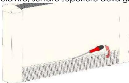
Ruotare leggermente la griglia. Il micro interruttore di sicurezza (indicato nel tondo) garantisce in ogni caso l'arresto del motore:
